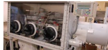
写真2:ウランを使用するためのグローブボックス
